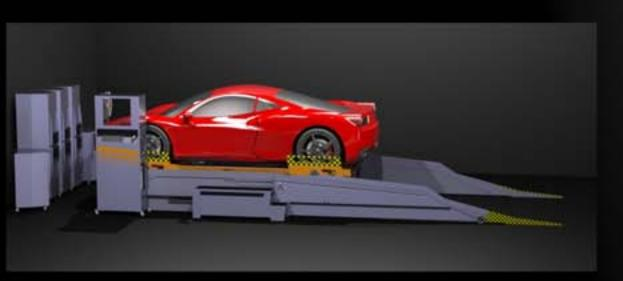
Véhicule en position d'essai. Le train de mise en place est légèrement redescendu, afin de laisser les roues en contact avec les rouleaux. En position basse, le train de mise en place est utilisé, par certains de ses éléments, de protection des éléments tournants et des projection.
